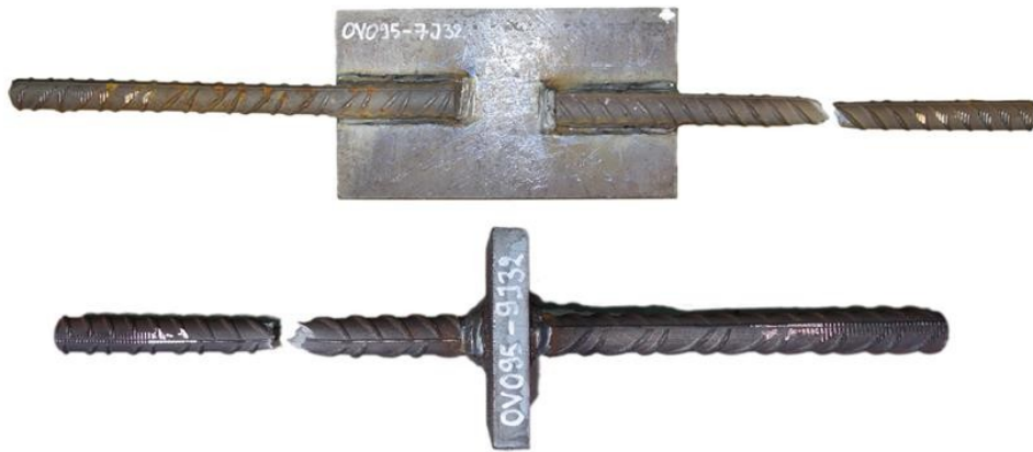
Deux types d'assemblages soudés après l'essai de traction: lap joint (au-dessus) et seton (en bas)
