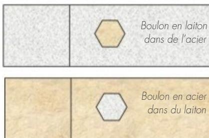
Effets de surface en cas de corrosion galvanique: deux tôles sont boulonnées. En raison d'un petit boulon non noble (acier) en combinaison avec une grande surface noble, la situation en dessous sera bien plus vite problématique que celle au-dessus
