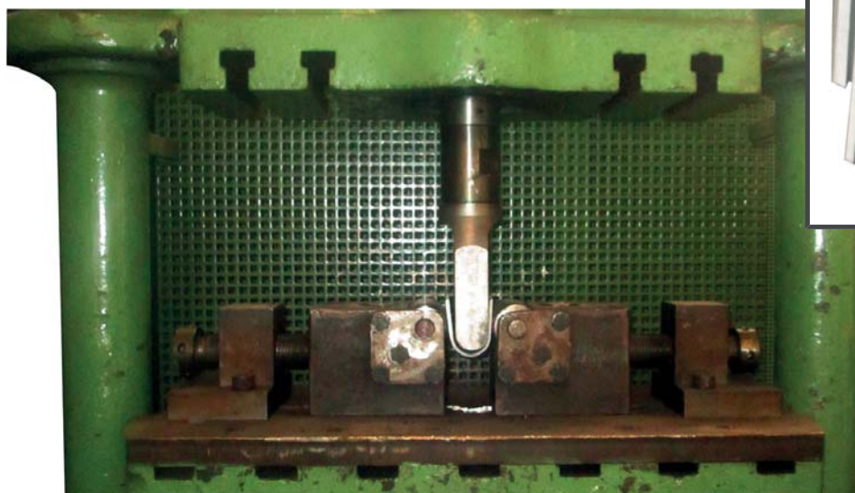
Dans d'autres configurations, des essais de 'macro' peuvent être réalisés avec une scie, une ponceuse et un peu d'acide, des essais de pliages demandent un peu plus de compétences, mais une simple presse d'atelier d'entretien, avec un outillage adapté
