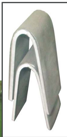
Dans d'autres configurations, des essais de 'macro' peuvent être réalisés avec une scie, une ponceuse et un peu d'acide, des essais de pliages demandent un peu plus de compétences, mais une simple presse d'atelier d'entretien, avec un outillage adapté
