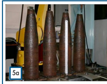
Figure 4: essais MX3D projet de fabrication additive de structure de pont [3]
