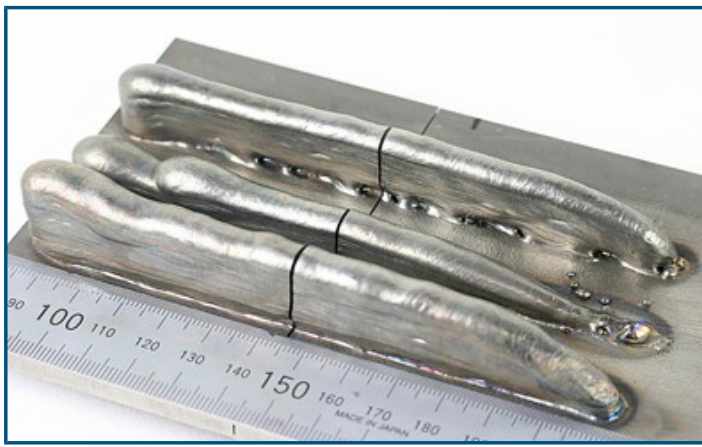
Figure 8: exemple de 'mur' de Ti6Al4V par Plasma+fil [2]
