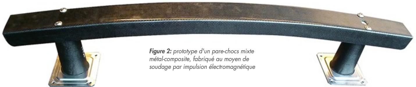
**Figure 2:** prototype d'un pare-chocs mixte métal-composite, fabriqué au moyen de soudage par impulsion électromagnétique
