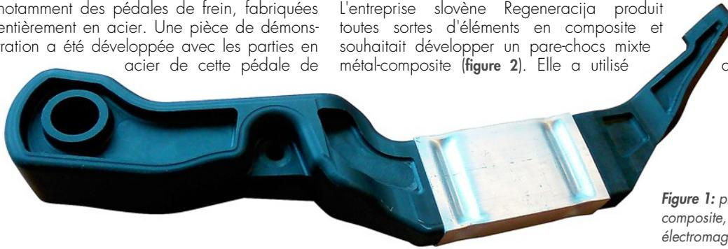
**Figure 1:** prototype d'une pédale de frein mixte métal-composite, fabriquée au moyen de retrait par impulsion électromagnétique
