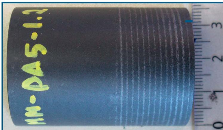
**Figure 11b:** indentations du filet de vis du tube en aluminium dans la barre en polyamide renforcé par fibre de verre courte (source: Institut Belge de la Soudure)
