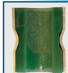
**Figure 8a:** coupe transversale d'un assemblage par retrait, reposant sur un assemblage basé sur la forme (2e concept d'assemblage), entre un tube d'aluminium et un tube en époxy renforcé par fibre de verre longue (EP GC22) (source: IBS)
