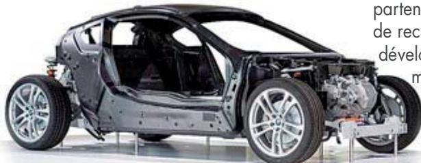
Figure 2: BMW i8 Voiture électrique fabriquée en aluminium et en composite renforcé par fibre de carbone [2]
