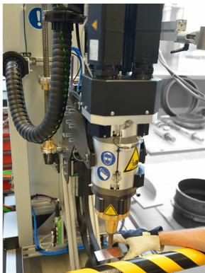
Figure 10: Appareil de soudage par points par friction dans l'Institut Belge de la Soudure
