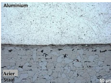
Figure 7: Coupe métallographique d'un assemblage soudé aluminium-acier (Source: Institut Belge de la Soudure)
