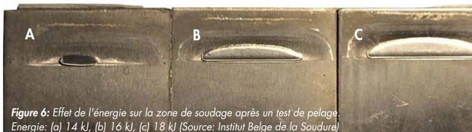
Figure 6: Effet de l'énergie sur la zone de soudage après un test de pelage. Energie: (a) 14 kJ, (b) 16 kJ, (c) 18 kJ (Source: Institut Belge de la Soudure)
