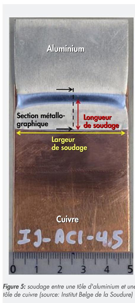
**Figure 5:** soudage entre une tôle d'aluminium et une tôle de cuivre (source: Institut Belge de la Soudure)
