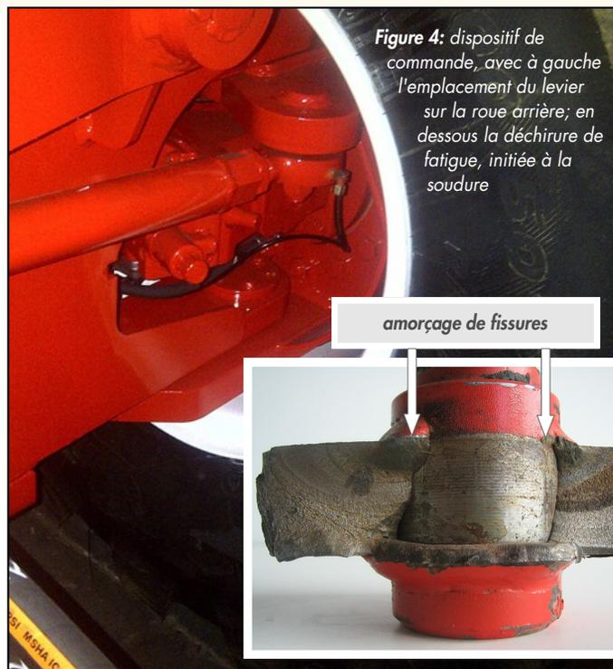
Figure 4: dispositif de commande, avec à gauche l'emplacement du levier sur la roue arrière; en dessous la déchirure de fatigue, initiée à la soudure
