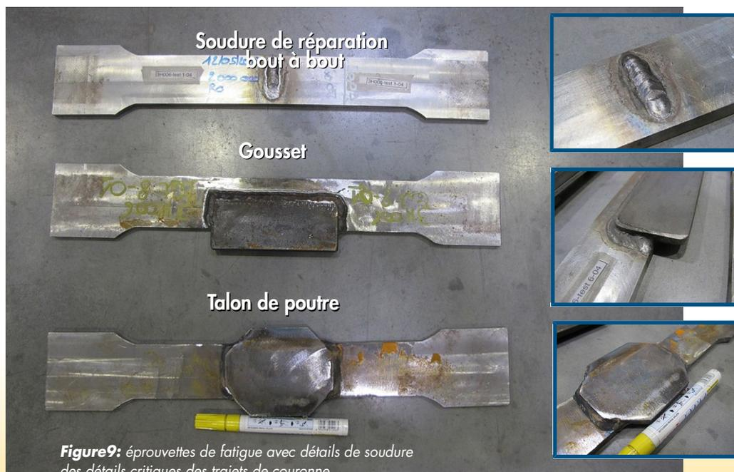
**Figure 9:** éprouvettes de fatigue avec détails de soudure des détails critiques des trajets de couronne
