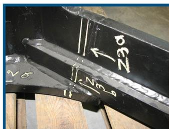
Cela se fait dans une préparation de soudure en X pour l'exécution d'un soudage de réparation bout à bout avec électrodes enrobées.
