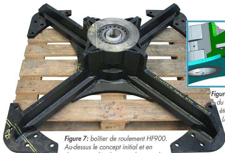
**Figure 7:** boîtier de roulement HF900. Au-dessus le concept initial et en dessous un détail avec indication de
