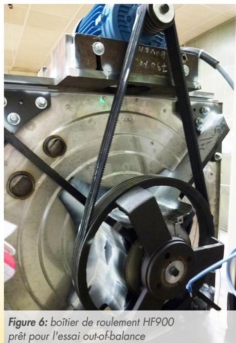
Figure 6: boîtier de roulement HF900 prêt pour l'essai out-of-balance
