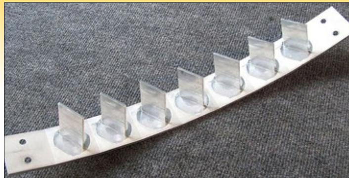
**Figure 12:** soudage par friction-malaxage de l'aluminium 2xxx à l'aluminium 6xxx (application aéronautique; source: CEWAC)
