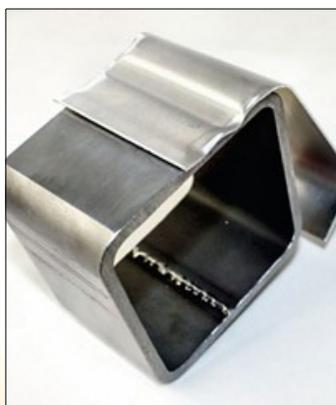
**Figures 14a et 14b:** soudage par impulsion magnétique de tôles (source: PSTproducts)
