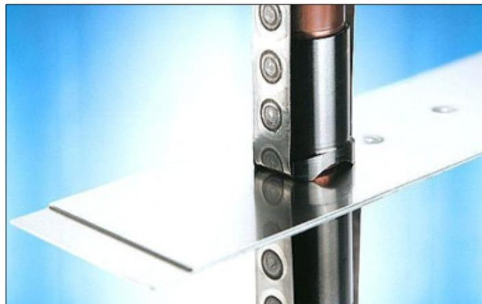
Figure 1: soudage par résistance avec bande process (source: Fronius)
