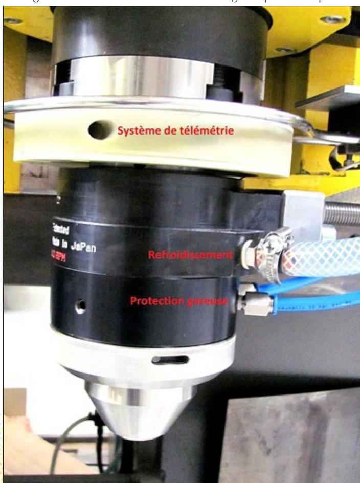
Figure 2 : tête de soudage FSW adaptée pour le soudage de l'acier
