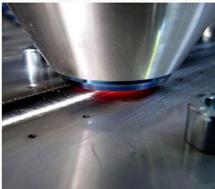
Figure 1 : soudage FSW de l'acier, l'échauffement de la tôle est parfaitement visible
