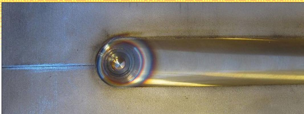
Figure 3: cordon de soudure réalisé sur de l'acier 304L
