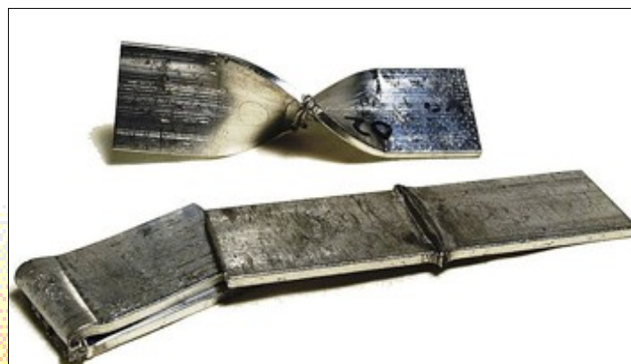
Figure 12: Soudage par friction orbital de plaquettes d'aluminium (source: Dyconn)
