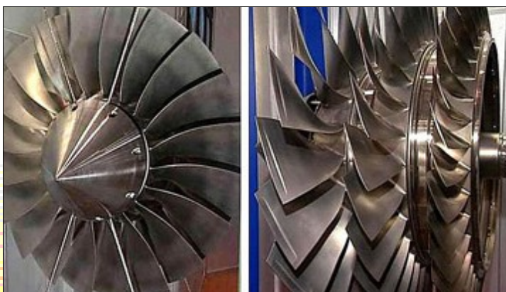
Figure 11: Aubes de turbine soudées par friction (source: TWI)
