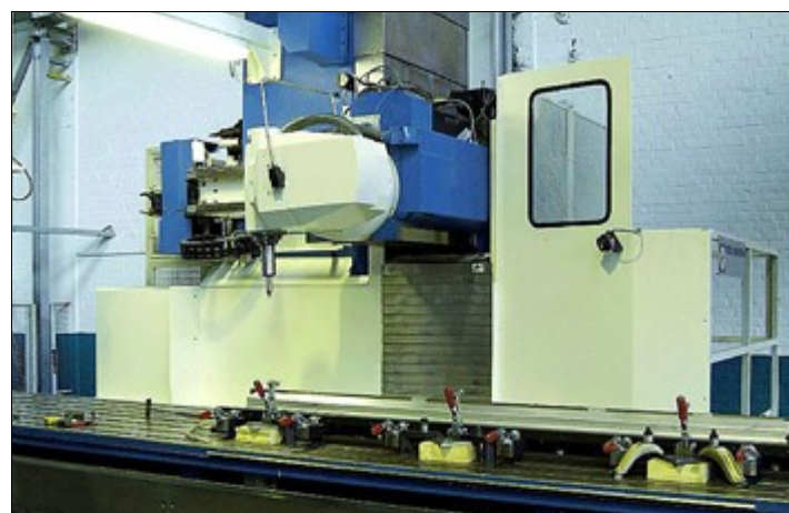
Figure 5: machine de soudage par friction-malaxage à Sapa RC Profiles à Ghlin
