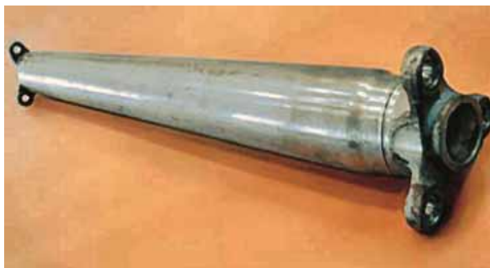
Figure 8: Arbre de commande constitué d'un tuyau en aluminium et de pièces en acier, assemblés avec le soudage par impulsion magnétique. Source: Pulsar
