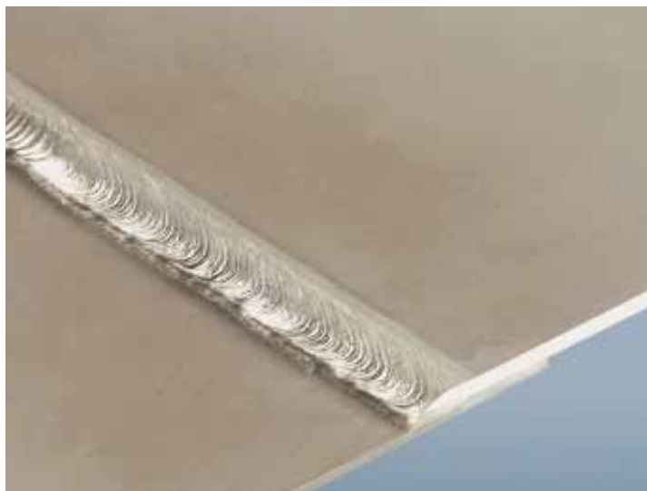
Figure 3: Soudure à recouvrement réalisée avec le procédé CMT entre une tôle supérieure en aluminium et une tôle inférieure en acier. Sur la figure de droite, on peut voir que l'aluminium est en fait brasé à l'acier. Source: Fronius
