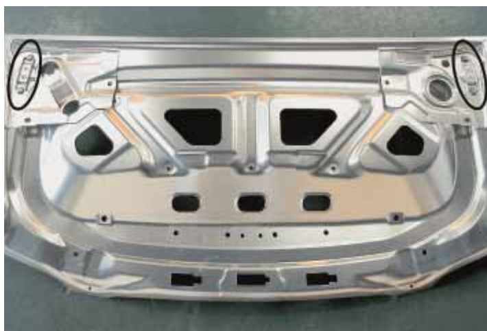
Figure 7: Mazda MX-5 (au-dessus), la première application commerciale du friction stir spot welding (FSSW) entre l'aluminium et l'acier galvanisé. Le couvercle de coffre (en dessous) est assemblé à l'aide du FSSW avec des boulons d'ancrage (coins supérieurs à gauche et à droite). Source: Mazda
