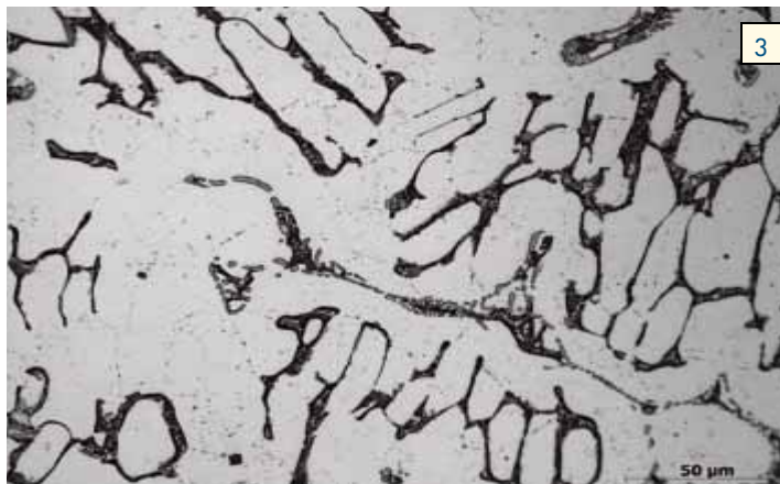
Figure 3: Une pièce coulée en AISI 316 a été refroidie trop lentement. Par conséquent, la ferrite delta s'est transformée en grande partie en phase sigma (deuxième phase plus sombre). A certains endroits, on distingue encore de la ferrite delta (plus claire que la phase sigma) Figure 5: Cassure dans un élément d'une installation de résine en acier inoxydable duplex. Cette pièce a été nettoyée tous les deux mois durant 1 h à 420-450 °C. Après 2 ans est apparue de la fragilisation à 475 °C. A gauche, on voit la fissure qui traverse la ferrite et évite l'austénite plus ductile
