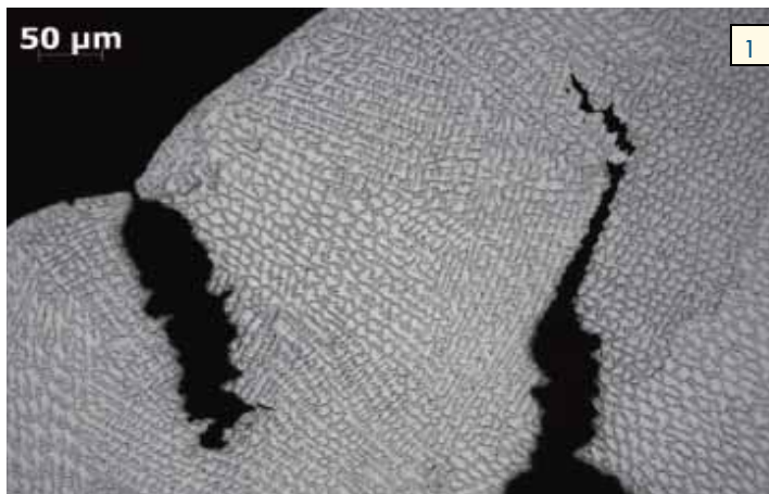
Figure 1: Fissuration à chaud dans le métal déposé d'une pièce coulée et d'une tôle, en AISI 316, soudées en TIG sans métal d'apport
