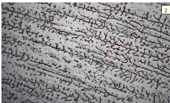
Figure 2: Soudure en AISI 304 avec quelques pourcents de ferrite delta
