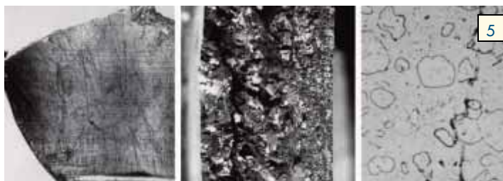
Figure 3: Une pièce coulée en AISI 316 a été refroidie trop lentement. Par conséquent, la ferrite delta s'est transformée en grande partie en phase sigma (deuxième phase plus sombre). A certains endroits, on distingue encore de la ferrite delta (plus claire que la phase sigma) Figure 5: Cassure dans un élément d'une installation de résine en acier inoxydable duplex. Cette pièce a été nettoyée tous les deux mois durant 1 h à 420-450 °C. Après 2 ans est apparue de la fragilisation à 475 °C. A gauche, on voit la fissure qui traverse la ferrite et évite l'austénite plus ductile
