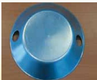
Figure 8: formage et perforation par impulsion magnétique
