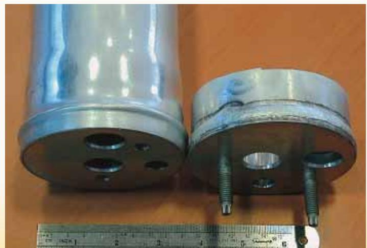
Figure 4: soudure par impulsion magnétique et soudure MIG
