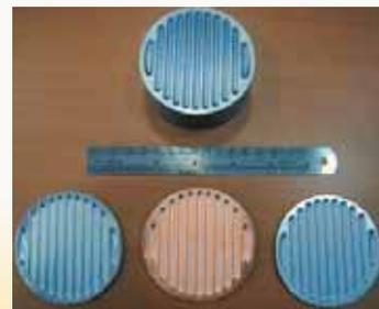
Figure 9: formage par impulsion magnétique
