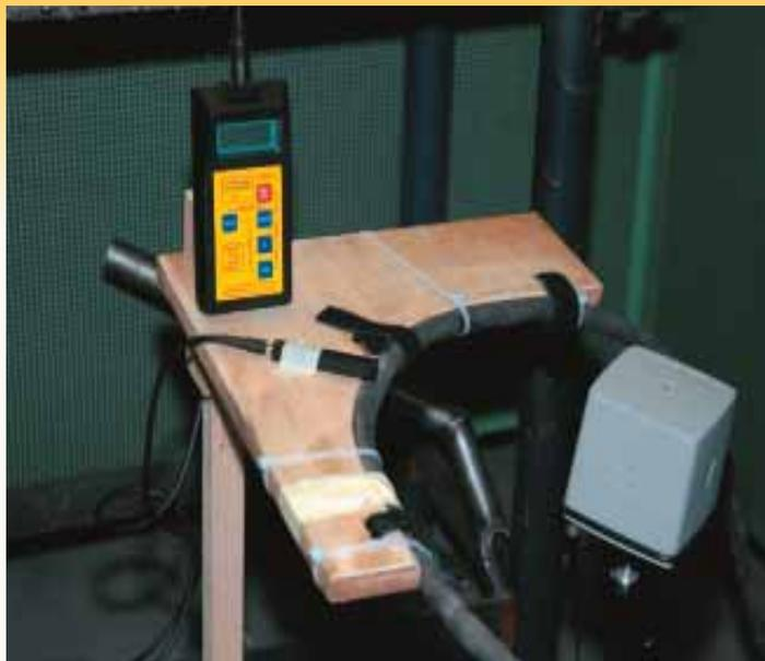
**Figure 5:** En plus de la mesure du courant, le champ magnétique est mesuré. Ce champ est mesuré, suivant la norme, au point central d'un conducteur de courant courbé (câble de masse) ayant un rayon de 20 cm
