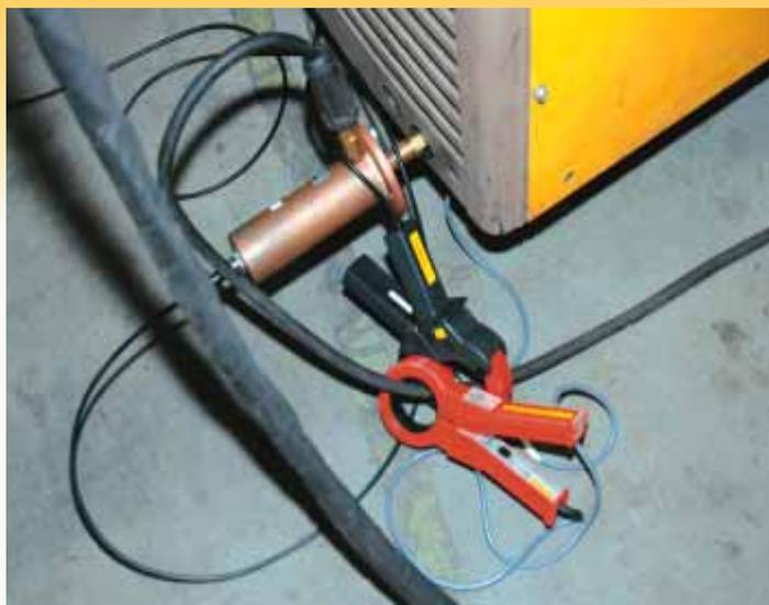
**Figure 2:** Le courant et la tension ont été mesurés de deux façons: au moyen d'un appareil de mesure (ALX) spécialement mis au point pour mesurer les paramètres de soudage (on a travaillé ici avec une pince électrique) et au moyen d'un shunt connecté en série avec le câble de masse. Le signal venant du shunt a été visualisé sur un oscilloscope
