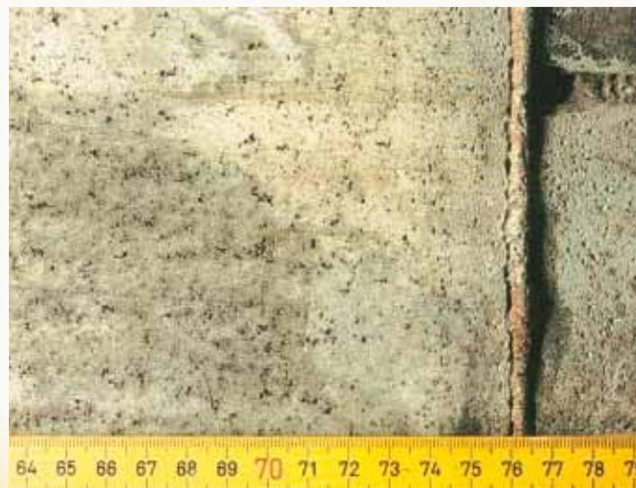
**Figure 8:** Corrosion en lame de couteau (knife-line attack) (ligne verticale juste à gauche de la soudure) dans l'AISI 316 Ti dans la même installation dont on a vu un détail à la fig. 2
