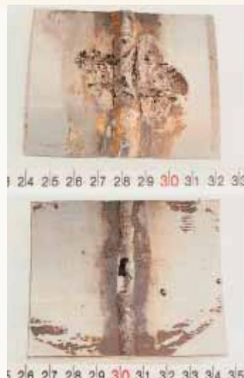
**Figure 1:** Corrosion localisée dans un tube en acier inoxydable duplex 2205 (dessus: extérieur, dessous: intérieur du tube) due à la présence d'oxydes thermiques dans la zone de la soudure
