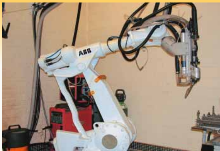
Figure 3: Equipement expérimental à VITO pour le soudage au laser hybride dans le cadre de HYLAS
