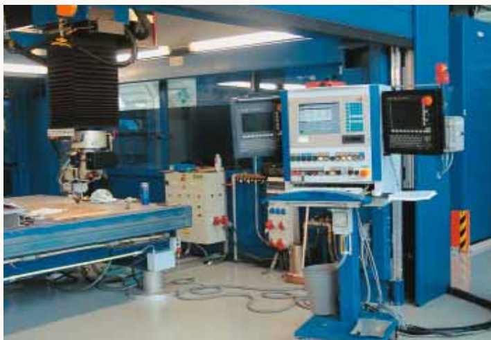
Figure 4: Equipement expérimental à OCAS pour le soudage au laser hybride dans le cadre de HYLAS
