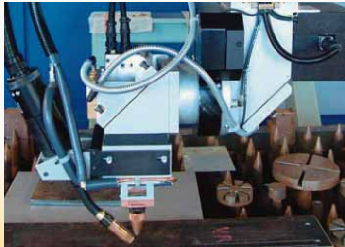
Figure 2: Réalisation de têtes de soudage au laser hybride au VITO (à gauche) et à OCAS (à droite)
