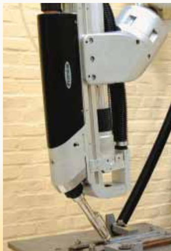
Figure 2: Réalisation de têtes de soudage au laser hybride au VITO (à gauche) et à OCAS (à droite)
