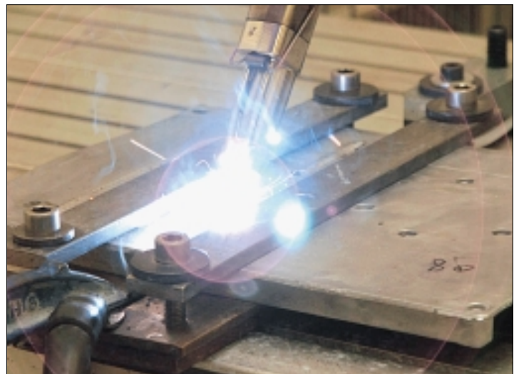
Figure 2: HLW au Lasercentrum Vlaanderen (VITO): les tôles d'aluminium sont assemblées au moyen d'une tête de soudage hybride Fronius
