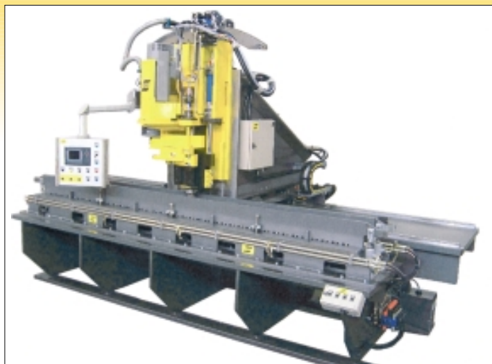
Figure 2: Grande machine friction stir welding de ESAB qui sera opérationnelle en 2006 au CEWAC (source: ESAB)
