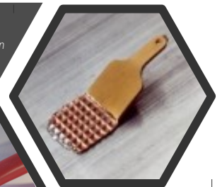
Ultrasoonlassen van koperen kabels (bron: Alpha bvba)
