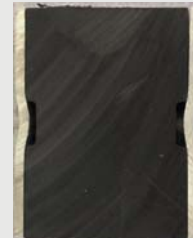
Figuur 8b: dwarsdoorsnede van een krimpvverbinding, gebaseerd op een vormverbinding (2e verbindingconcept), tussen een aluminium buis en een korte glasvezelversterkte polyamide staaf (PA6.6 GF30) (bron: Belgisch Instituut voor Lastechniek)
