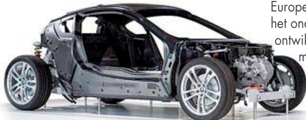
Figuur 2: BMW i8 Elektrische auto vervaardigd uit koolstofvezelversterkt composiet en aluminium [2]
