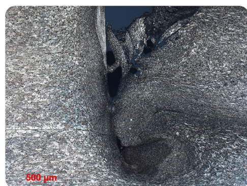
Figuur 6: detail van figuur 5: voorbeeld van lasfouten (bindingsfouten, porositeiten en onvolledige vulling)
