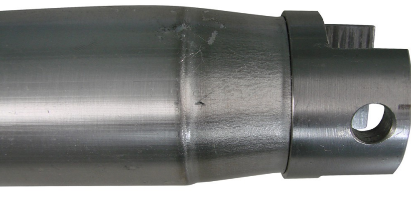
Fig. 11: Elektromagnetische puls las van aluminium aan staal in een drijf-as voor de automobiellindustrie (bron: PST Products GmbH, Duitsland) [4]
