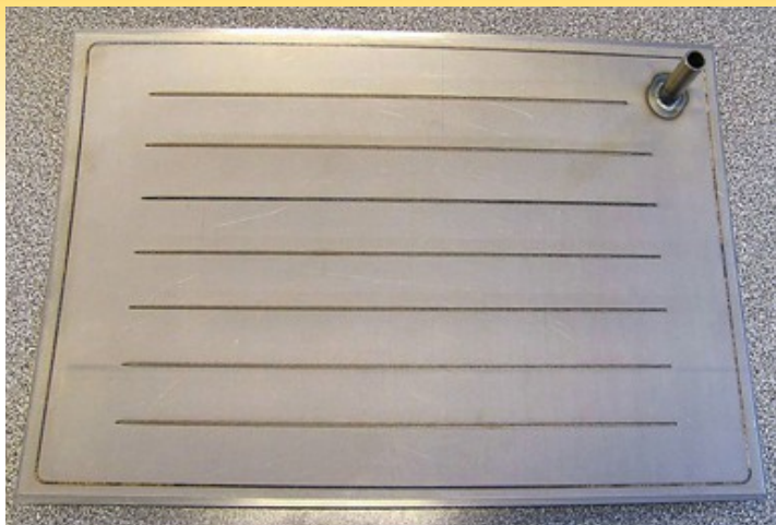
Afbeelding 5: toepassing microlaserlassen. Het doel was het vervaardigen van een demonstratiemodel van een absorptiepaneel voor zonne-energie
