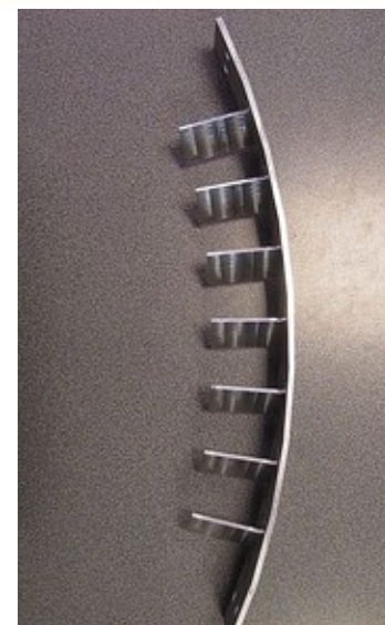
Afbeeldingen 1 en 2: toepassing van het gerobotiseerd microwrijvingsroerlassen. De verkregen resultaten waren heel bemoedigend aangezien een dichte lasverbinding met uitstekende mechanische eigenschappen kon worden gerealiseerd. Op basis daarvan werd ook een (3D) complex gebogen demonstratiemodel vervaardigd
