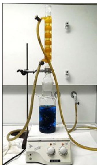
Figuur 2: dompeltest volgens ISO 3651-2 (koper-kopersulfaatoplossing)
