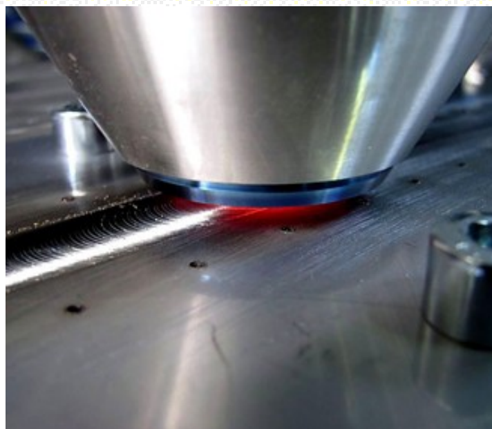
Figuur 1: FSW van staal, de opwarming van de staalplaat is goed zichtbaar
