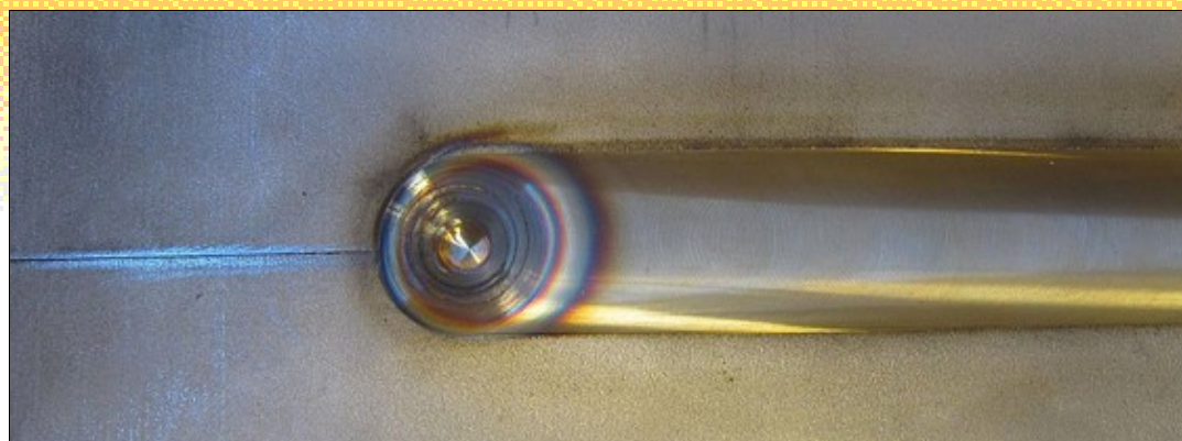
Figuur 3: lasnaad in roestvaststaal 304L
