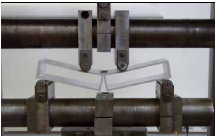
Figuur 4a: specifieke proefopstelling voor toepassing 1: vierpuntsbuiging opstelling (simulatie uniforme verdeelde belasting, zoals bulkgoederen, op een laadvloer) bij BIL
