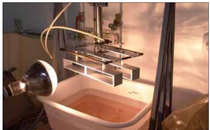
Figuur 4b: specifieke proefopstelling voor toepassing 1: dompelproef opstelling (simulatie blootstelling van onderzijde laadvloer aan dooizouten) bij UGent
