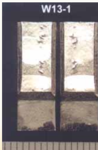
Figuur 5: Breukvlak van een CTOD-buigproefstuk. De machinaal vervaardigde kerf bevindt zich aan de onderkant. Het einde van de vermoeiingsscheur (lichter deel) is niet recht
