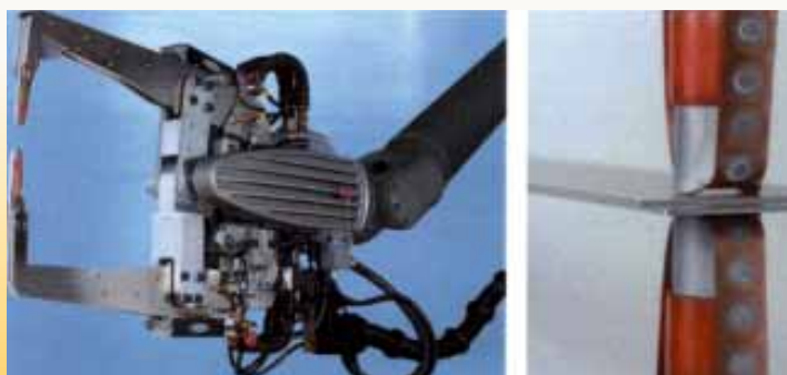
Figuur 1 (rechts): Weerstandlastang met geïntegreerde processtape Figuur 2 (boven) Verschil in warmteontwikkeling met dezelfde lasparameters (kracht, stroom, lastijd) bij het puntlassen van staal met proces tape (links) en bij het conventionele puntlassen zonder proces tape (rechts)
