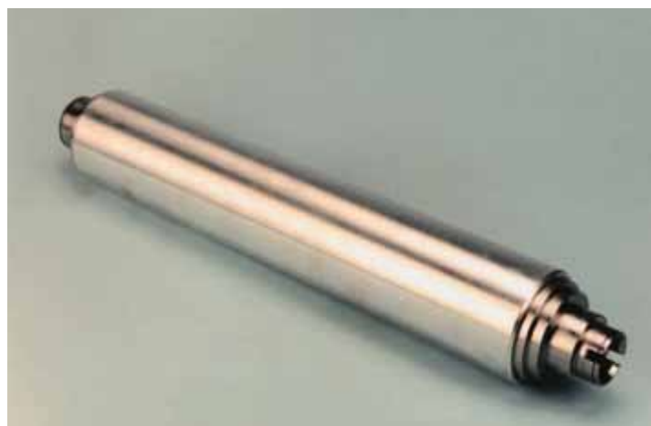
Figuur 5: Fotokopieermachine onderdeel, opgebouwd uit een aluminium schacht en roestvast stalen uiteinden, aan elkaar gelast met behulp van wrijvingslassen. Bron: Manufacturing Technology, Inc.
