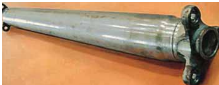
Figuur 8: Aandrijf-as, opgebouwd uit een aluminium buis, met magnetisch pullassen verbonden aan stalen verbindingstukken. Bron: Pulsar
