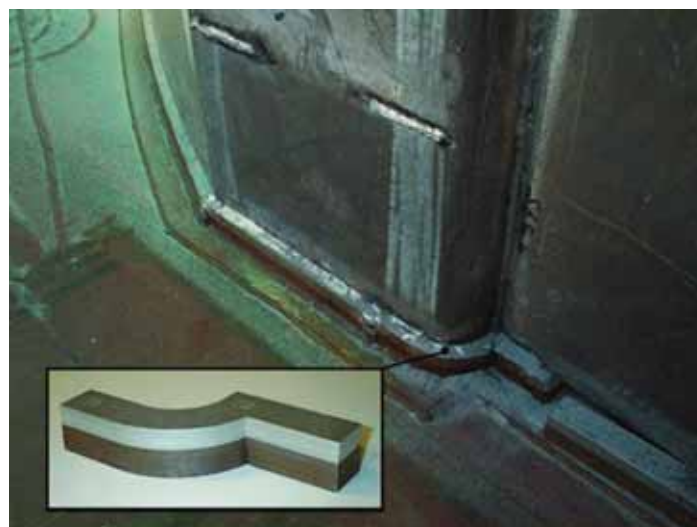
Figuur 1: Explosiegeplast overgangsstuk (zie in zelffoto) voor het verbinden van een stalen dek aan een aluminium bovenbouw in de scheepsbouw. Bron: Triplate®
