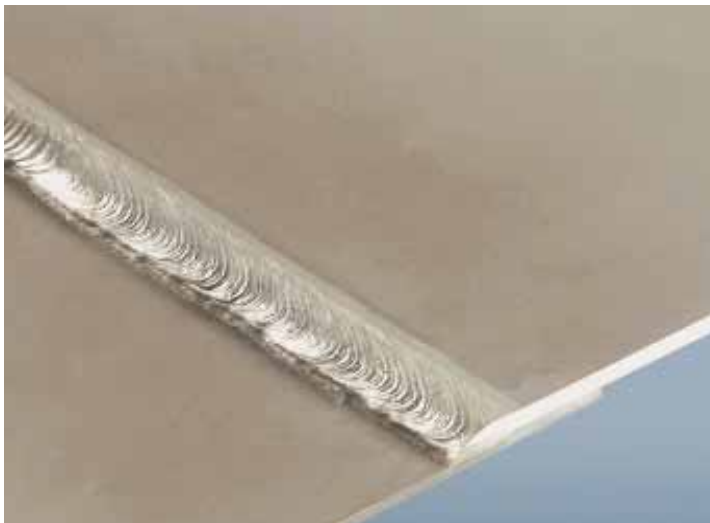
Figuur 3: Overlapverbinding gerealiseerd met het CMT proces tussen een aluminium bovenplaat en een stalen onderplaat. In de figuur rechts kan gezien worden dat het aluminium in feite aan het staal gebraseerd wordt. Bron: Fronius.
