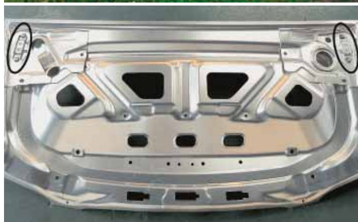
Figuur 7: Mazda MX-5 (boven), de eerste commerciële toepassing van friction stir spot welding (FSSW) tussen aluminium en gegalvaniseerd staal. Het kofferdeksel (onder) wordt met FSSW verbonden met boutverankeringen (linker- en rechterbovenhoek). Bron: Mazda
