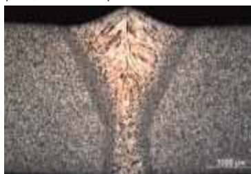
Figuur 6: metallografische doorsnede van een hybride laserlas in 5 mm dik S240D staal, uitgevoerd door VITO met lassnelheid 1,8 m/min, en 4,4 kW laservermogen (MH3/1 uit tabel 2)
