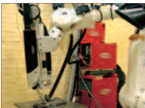
Figuur 3: Gerobotiseerde Nd:YAG-MIG/MAG hybride laserlasinstallatie van het Lasercentrum Vlaanderen (VITO)
