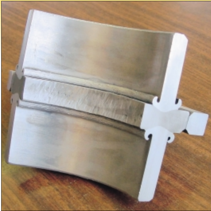
Figuur 2: Verbinding van twee vierduimse pijpen (mat.: API X42, wanddikte 8,5 mm)
