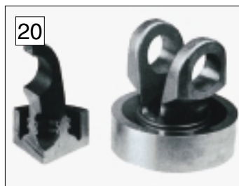
Verbinding van aluminium aan koper (figuur 17), verbinden van de klepstaal aan de schotel (figuur 18), voorbeelden van bimetallische verbindingen: aluminium/koper elektrische connectoren en titanium/koper tapeinden (figuur 19), zuiger van een dieselmotor (figuur 20)
