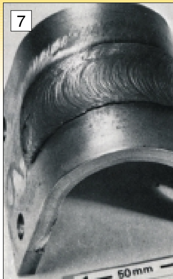
Destructieve beproeving van een opgelaste laag door middel van het wrijvingslasproces (figuur 7), herstellassen m.b.v. het friction stitch lasproces (figuur 8), principeschets van het friction stir welding proces (figuur 9), friction stir welding van velgen (figuur 10)
