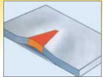
Fig. 6B: een kromgetrokken rand van een plaat als een alternatief voor walsen
