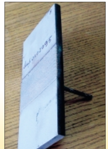
Figuur 7: plaat met staafje voor trekproef
