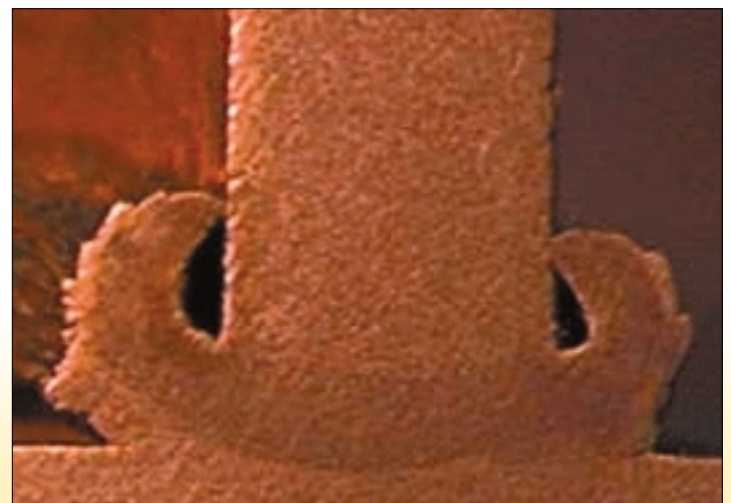
Figuur 3 en 4: De vergelijking tussen het gemodelleerde (links) en werkelijke (rechts) uitzicht van een lasverbinding
