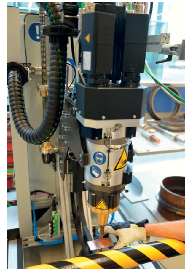
Figuur 9 Wrijvingspuntlastoestel bij het Belgisch Instituut voor Lastechniek
