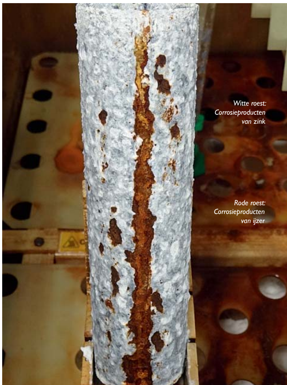
Figuur 1: voorbeeld van witte en rode roest op een verzinkt onderdeel. In dit geval vertoont het oppervlak reeds ongeveer 30% rode roest.
