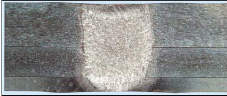
Figuur 6 : Lasverbinding in een AlMg 3 -plaatcombinatie van verschillende dikte (1-2-3 mm)
