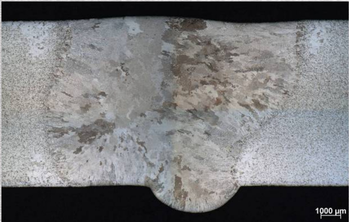
Figuur 25: AISI304 (8.5 mm) - A-TIG LDW10
