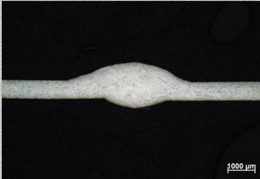
Figuur 30: AISI430 (0,7 mm) - Cold process (Cloos)
