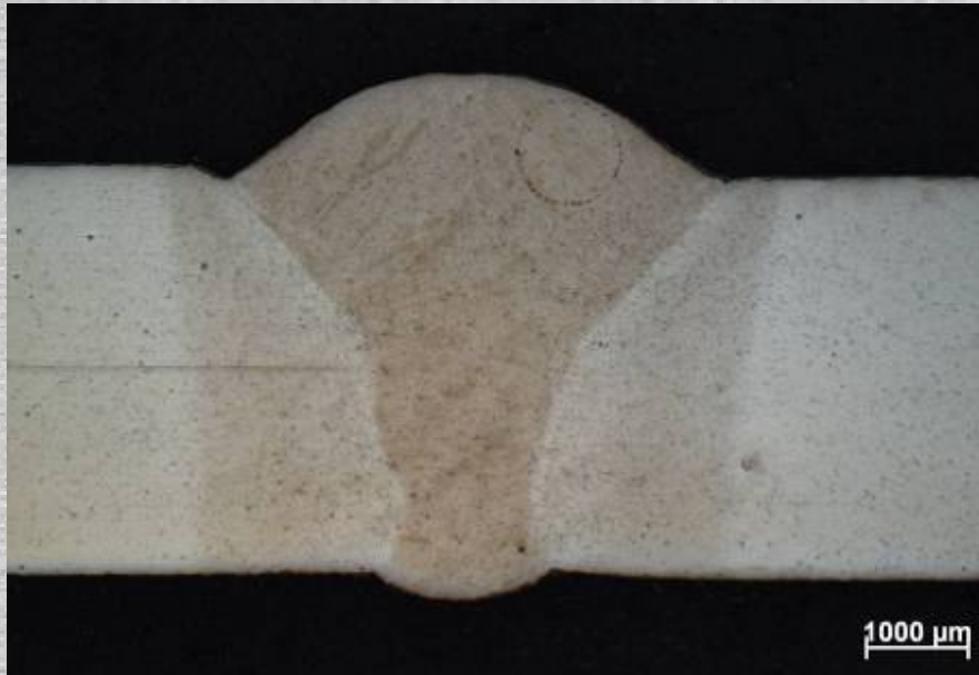
Figuur 9: S700MC (4 mm) - Gepulseerd MAG
