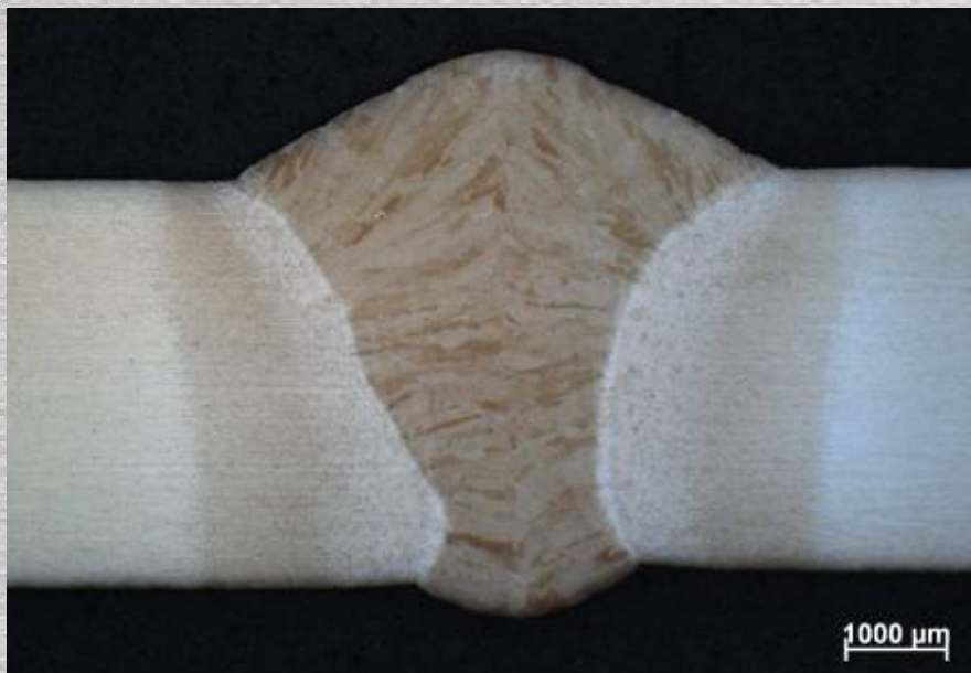
Figuur 12: S700MC (4 mm) - Cold Arc (EWM)
