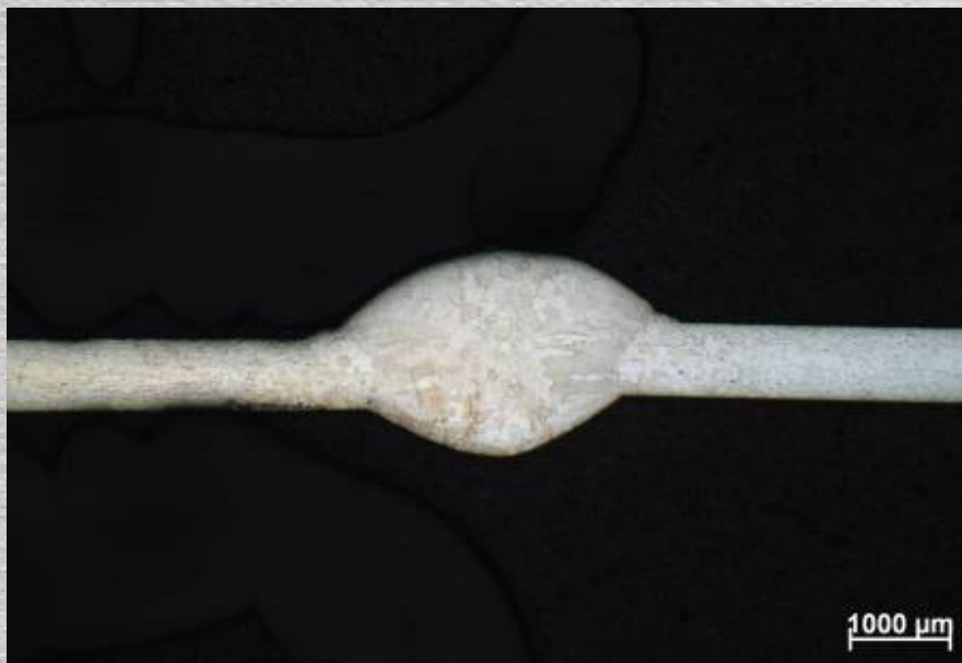
Figuur 27: AISI430 (0,7 mm) - Gepulseerd MAG
