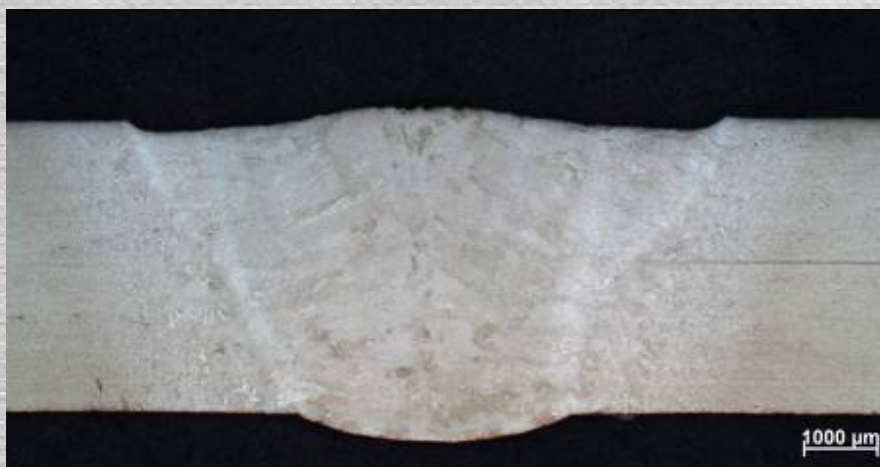
Figuur 16: S700MC (4 mm) - A-TIG YC27A
