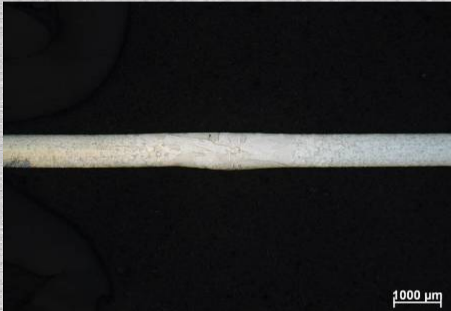
Figuur 26: AISI430 (0,7 mm) - Conventioneel TIG
