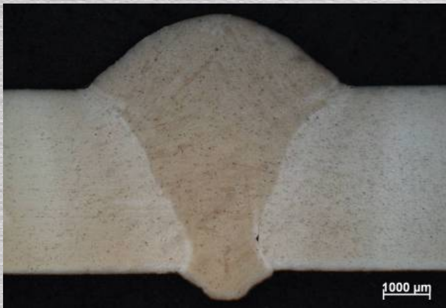
Figuur 10: S700MC (4 mm) - CMT (Fronius) (Afgekeurd wegens bindingsfout)
