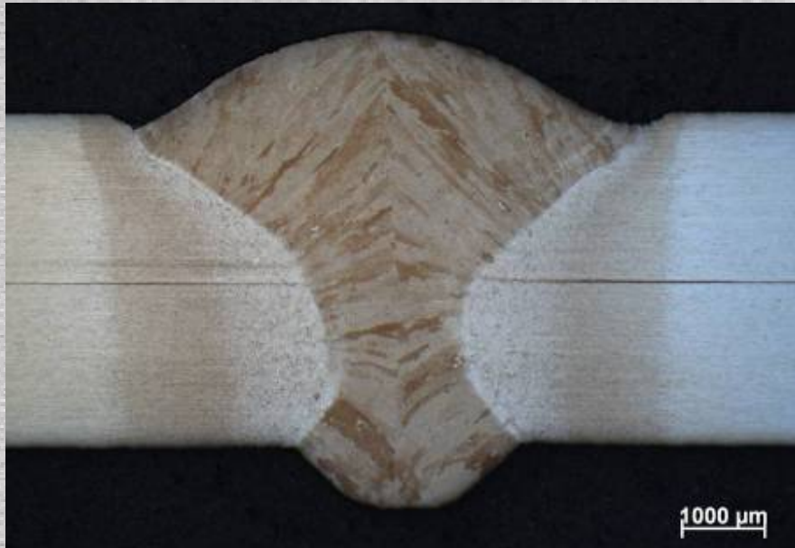
Figuur 11: S700MC (4 mm) - SPMAG (Valk welding)
