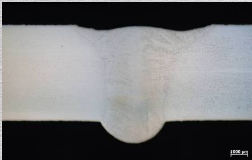
Figuur 23: AISI304 (6 mm) - A-TIG LDW10
