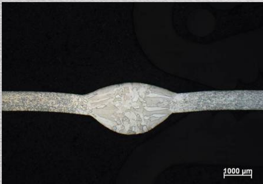
Figuur 31: AISI430 (0,7 mm) – Cold Arc (EWM)
