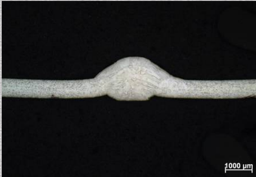
Figuur 28: AISI430 (0,7 mm) - CMT (Fronius)
