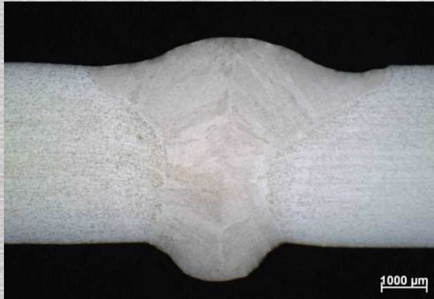
Figuur 18: AISI304 (4 mm) - Conventioneel MAG
