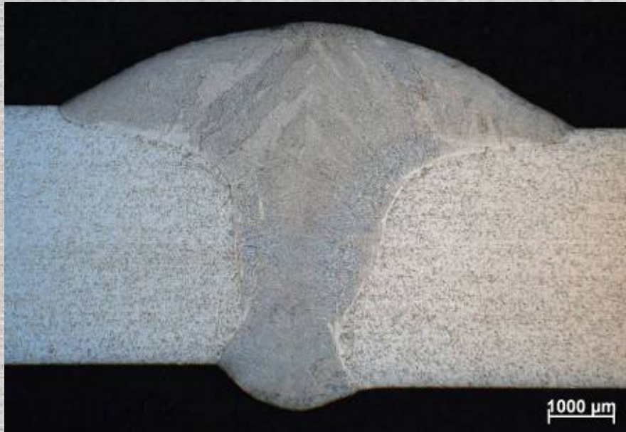
Figuur 20: AISI 304 (4 mm) - Cold Arc (EWM)
