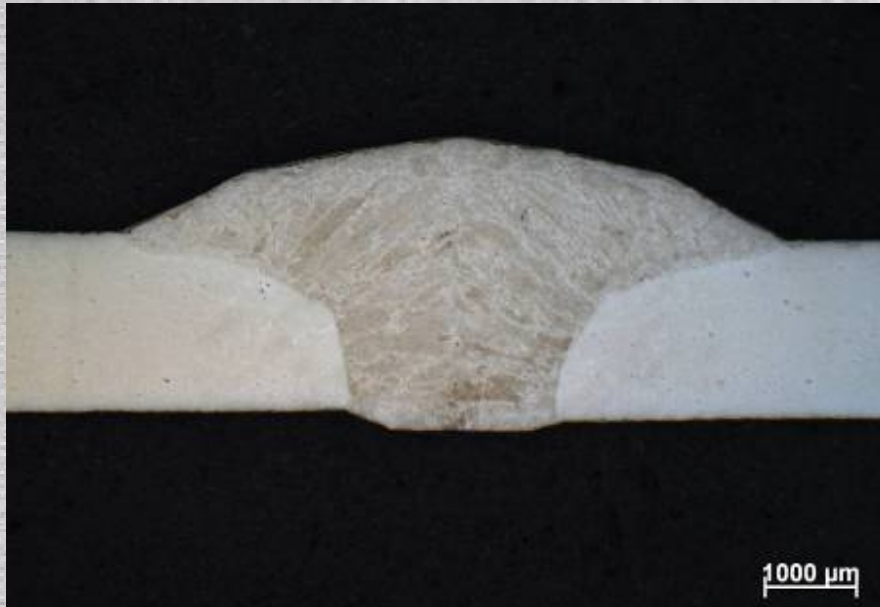
Figuur 5: DC01 (2 mm) - SPMAG (Valk Welding)
