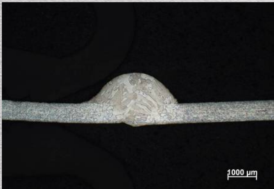
Figuur 29: AISI430 (0,7 mm) - SPMAG (Valk welding)
