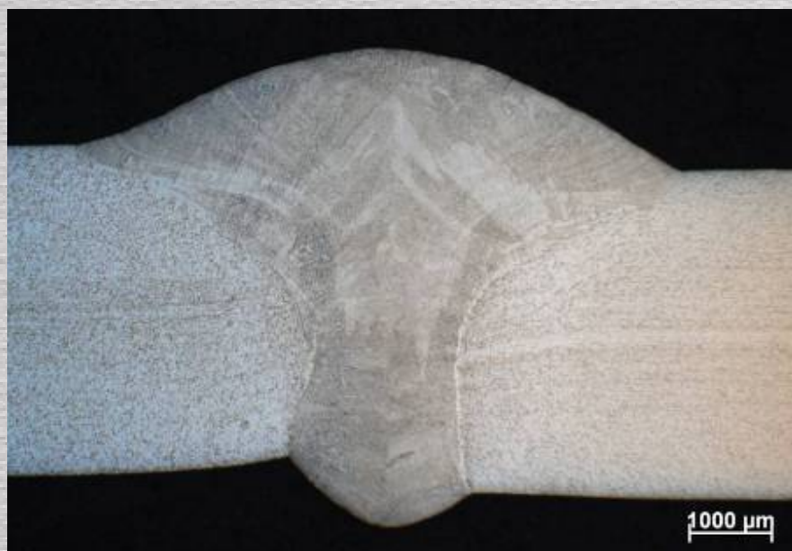
Figuur 19: AISI 304 (4 mm) - SPMAG (Valk Welding)
