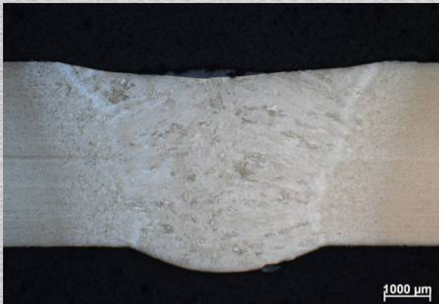
Figuur 16: S700MC (4 mm) - A-TIG YC27A
