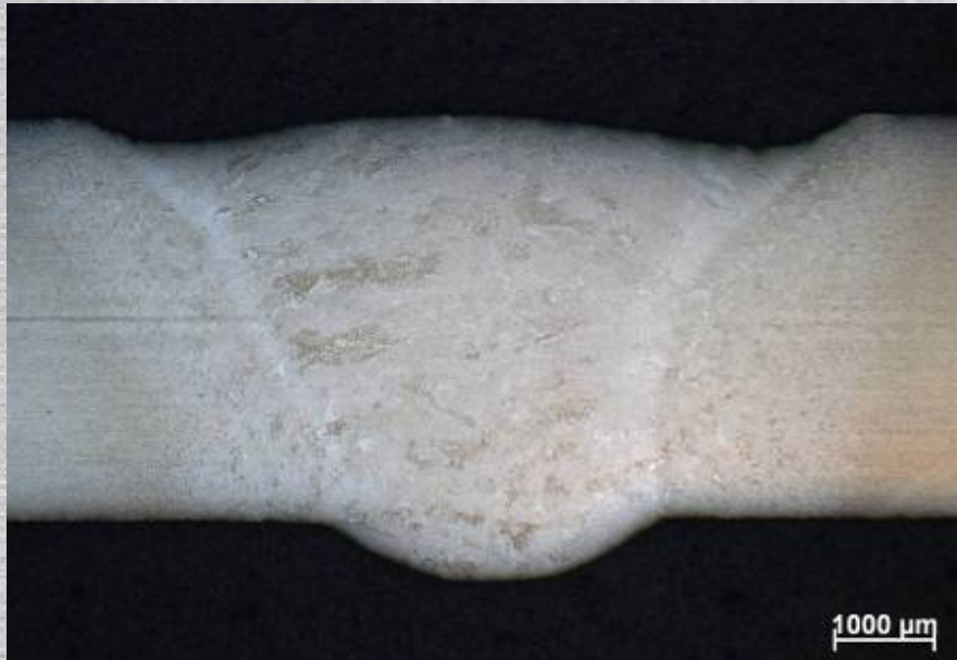
Figuur 13: S700MC (4 mm) - Conventioneel TIG
