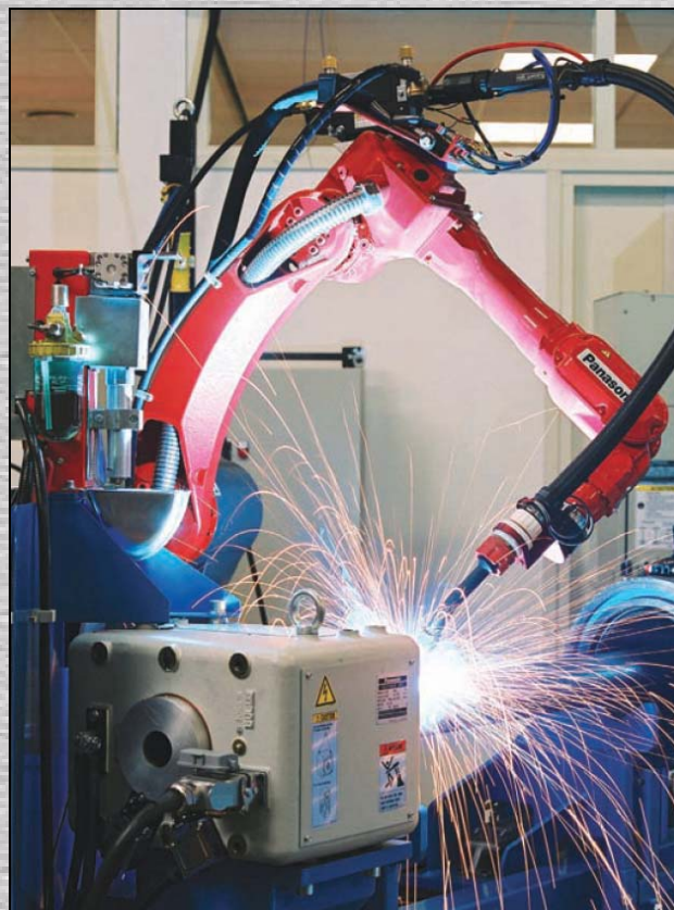
Figuur 1 : Panasonic Tawers lasrobot in bedrijf bij Case New Holland in Zedelgem (foto: Valk Welding)
