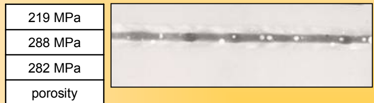
Laser-MIG: 1 mm 2 m/min
