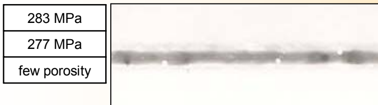
Laser-MIG: 1 mm 1,5 m/min
