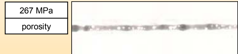
Laser-MIG: 2 mm 2 m/min
