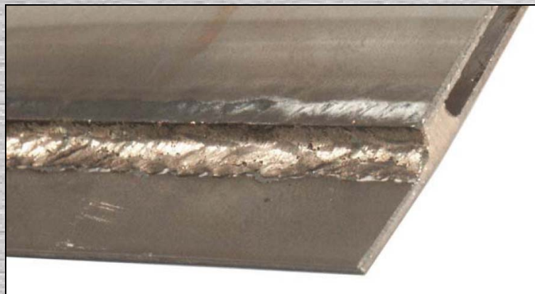
Figuur 3 : Manueel ColdArc gebrazeerde verbinding van 0,8 mm verzinkte stalen plaat
