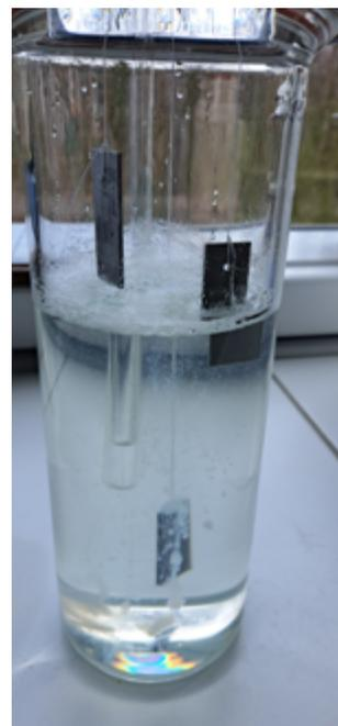
Configuration pour l'essai CLP. Une plaque est entièrement immergée, une plaque est suspendue à mi-hauteur et une troisième plaque est suspendue au-dessus du liquide en phase vapeur.
