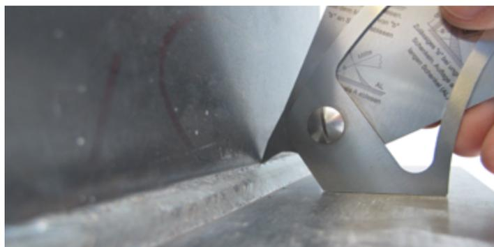
Mesure du diamètre de la gorge d'une soudure d'angle
