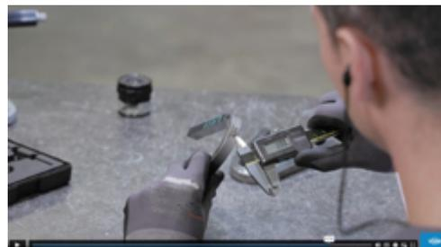
La mesure des imperfections après l'exécution d'un test de pliage
