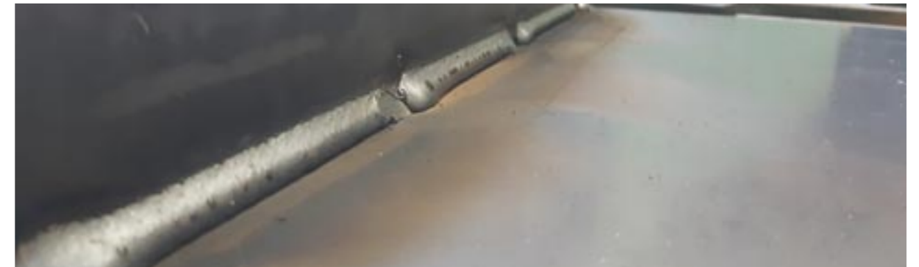
Figuur 1 Testopstelling gebruikt voor hoeklassen (Bron: BIL) (linkerpagina en hierboven)
