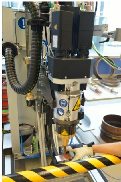
L'objectif de ce projet est de développer le procédé de soudage par points par friction en combinaison avec une étanchéité. Un nouveau type d'assemblage étanche a été conçu à cet effet, comprenant une méthode de traitement de surface préalable.
