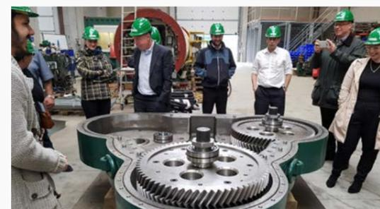
Boîte d'engrenage de la machine de soudage par friction orbital
