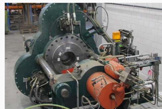
Machine pour le soudage par friction orbital
