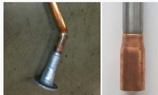
Pièce de démonstration pour REFCO : assemblage tubulaire en cuivre-acier. Fait par brasage (à gauche), fait par impulsion magnétique (à droite)
